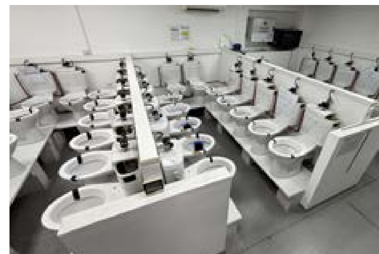
Plus de 50 WC sont nécessaires pour vérifier la durée de vie des blocs WC.
